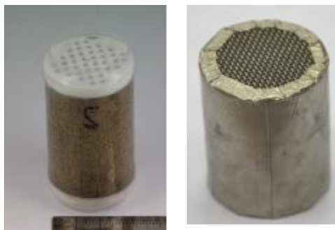
Рис. 38 Образцы изготовлены с помощью обсадки в термоусадочную пленку и никелевую фольгу
