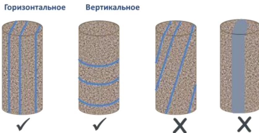
Рис. 34 Требования к направлению изготовления образцов
