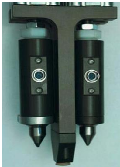
Рис. 17 Комбинированный блок зонда ультразвуковой скорости и зонда измерения проницаемости
