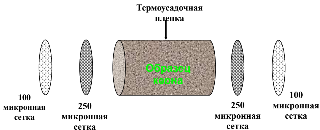
Рис. 36 Схема образца изготовленного методом вдавливания
