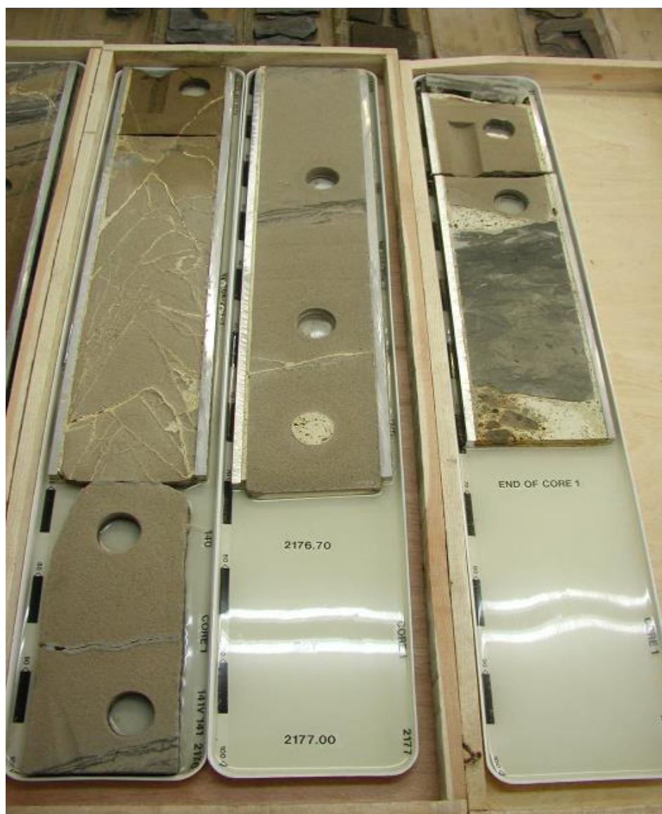
Рис. 7 Продольно распиленные части керна толщиной в 1 см размещенные в специализированных лотках
