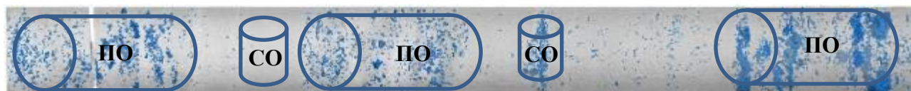
Рис.33 Пример разметки кавернозного керна по результатам РКТ ПО – полноразмерный образец, СО – стандартный образец
